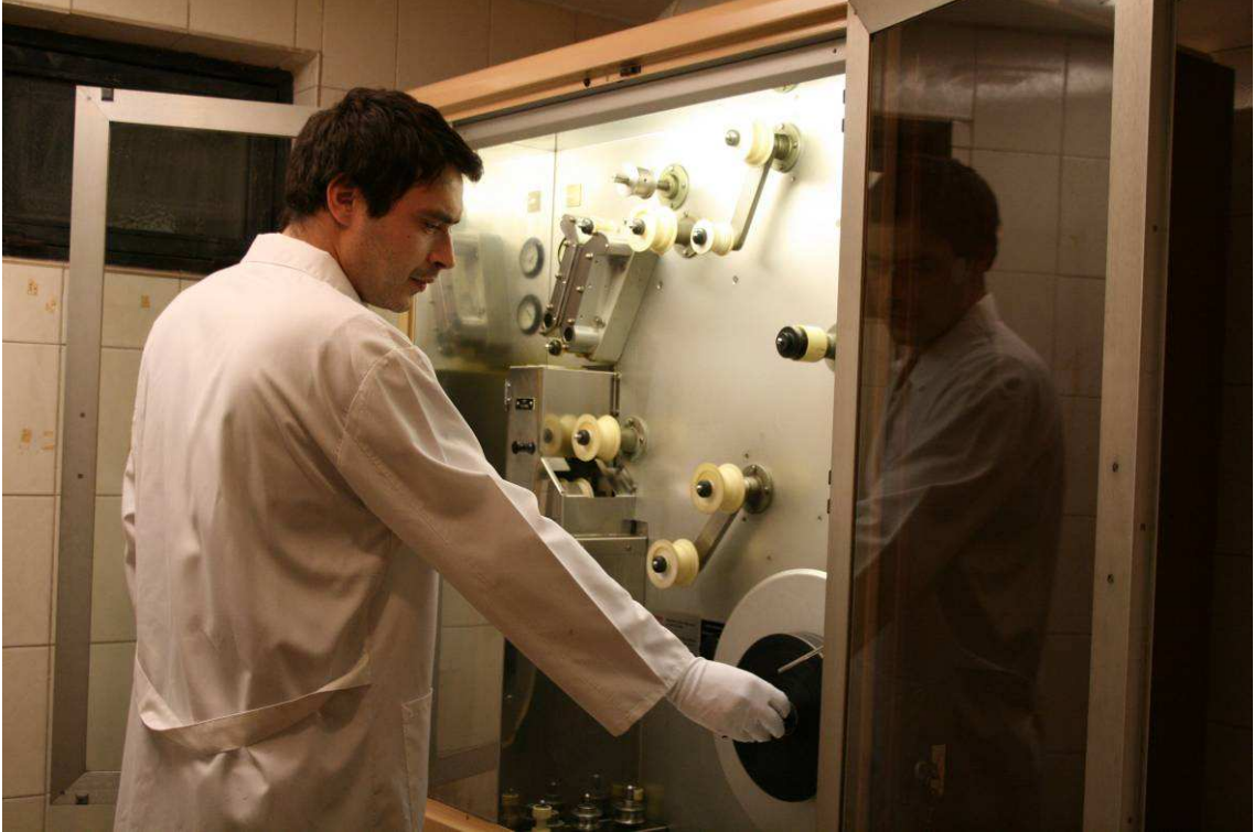
Filmler özel bir solventle temizleniyor, yağ ve tozdan arındırılıyor.
